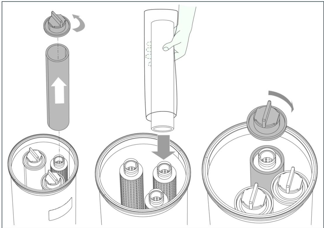
1. Schrauben Sie die Hutmutter ab.
