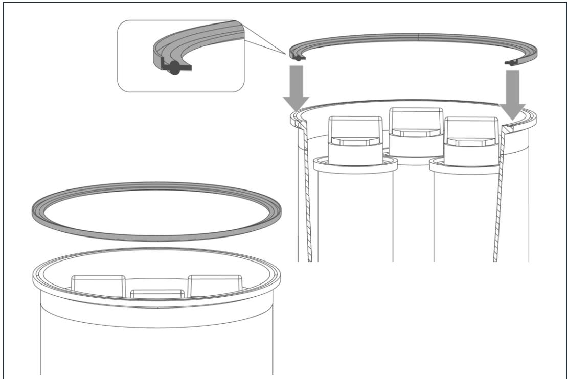
1. Prüfen Sie die Clamp-Dichtung auf Verschleiß.
