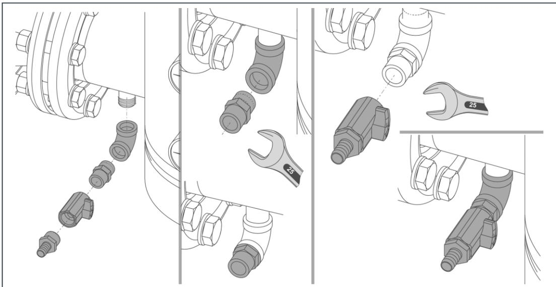
1. Schrauben Sie den 90° Winkel an den Filter-Anschluss.
