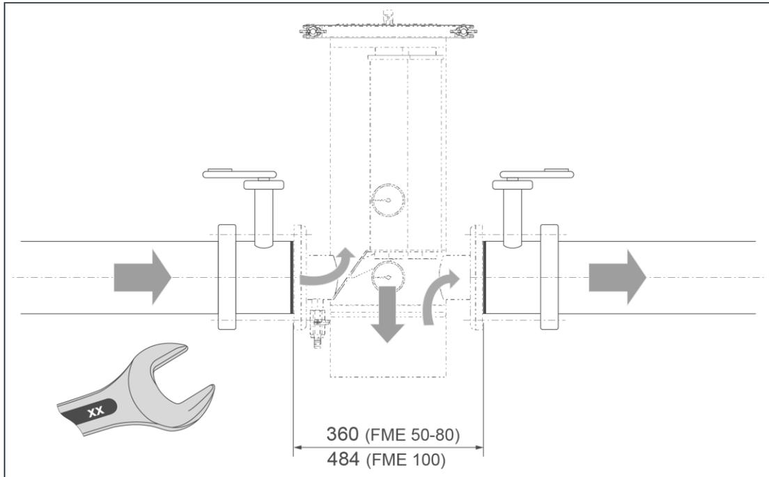
1. Bereiten Sie die Rohrleitung mit Flanschbindung nach DIN EN 1092-1 vor.
