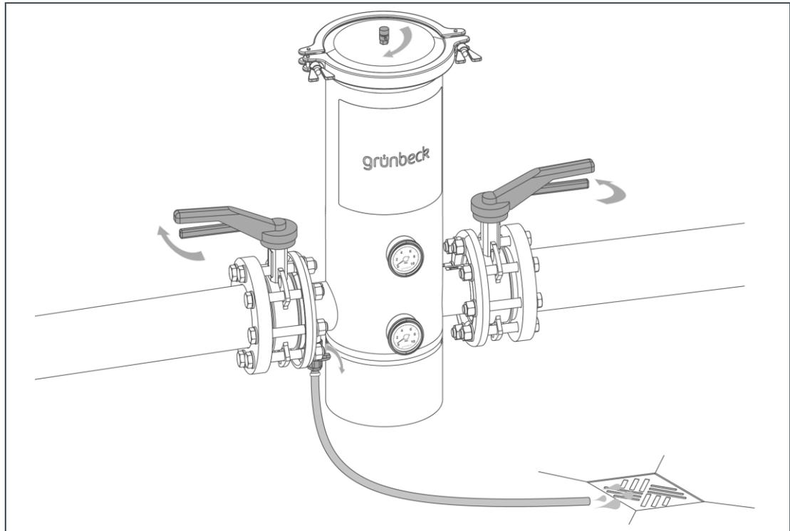
1. Führen Sie die Abwasserleitung zum Abwasserkanal.
